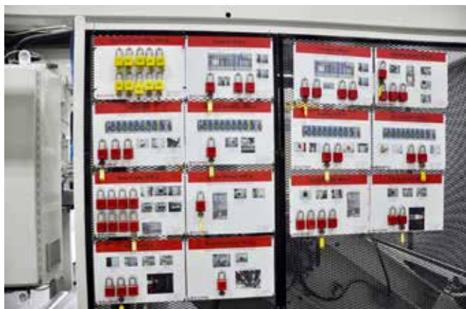
△ Onderhoudssloten van de secties met persoonlijke sloten (geel).
